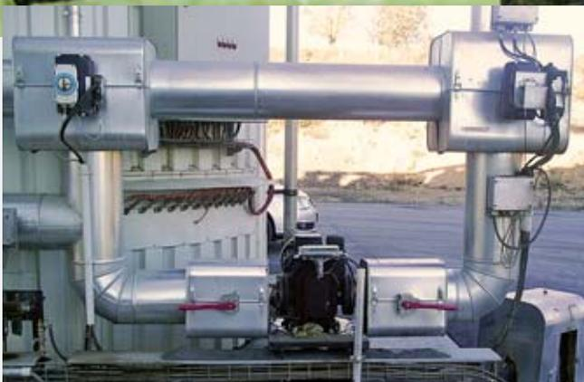
Elektrisch beheizte Pumpe einer Bitumenanlage zur Förderung von flüssigem Heiss-Bitumen
