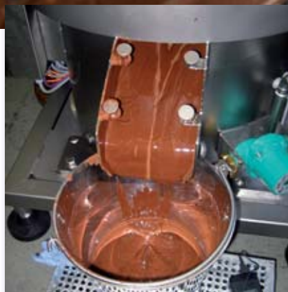
Zentrifuge für die Bearbeitung von Re-work-Schokolade: Trennung von Bruchschokolade (links) in flüssige (mitte) und feste Bestandteile (rechts)
