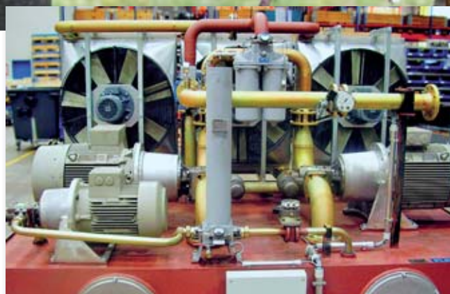
Schmierölpumpen zur Versorgung eines Getriebes im Maschinenbau
