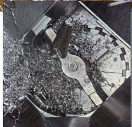
Spänezerkleinerer zur Volumenreduktion in der Metall- und Kunststoffbearbeitung
