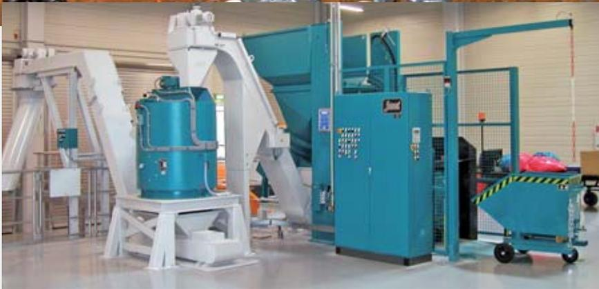
Anlage zur Rückgewinnung von Kühlschmierstoffen (KSS) aus den bei der Metallbearbeitung (Drehen, Fräsen, Bohren) anfallenden Spänen
