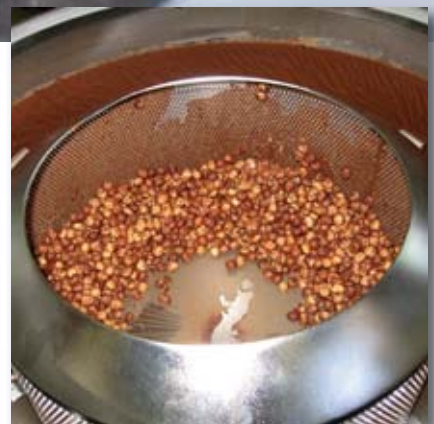
Zentrifuge für die Bearbeitung von Re-work-Schokolade: Trennung von Bruchschokolade (links) in flüssige (mitte) und feste Bestandteile (rechts)
