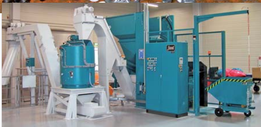
Anlage zur Rückgewinnung von Kühlschmierstoffen (KSS) aus den bei der Metallbearbeitung (Drehen, Fräsen, Bohren) anfallenden Spänen
