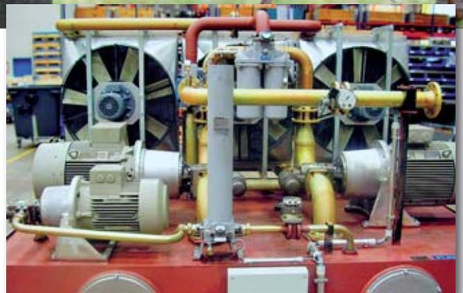
Schmierölpumpen zur Versorgung eines Getriebes im Maschinenbau
